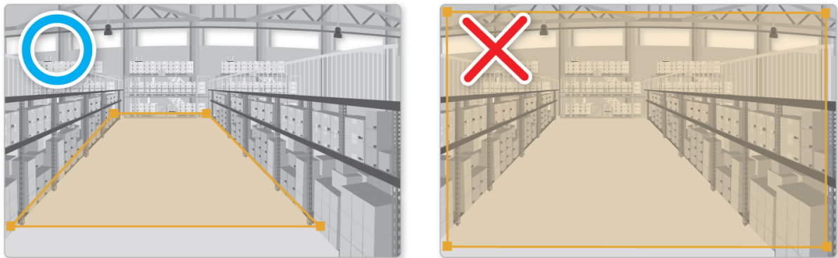
그림 2. (좌)권장하는 감지 영역 설정, (우)권장하지 않는 감지 영역 설정의 예
