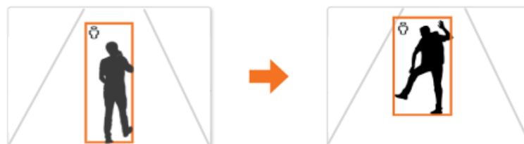
図 7：カメラの光軸方向に沿って転倒する人物の例
