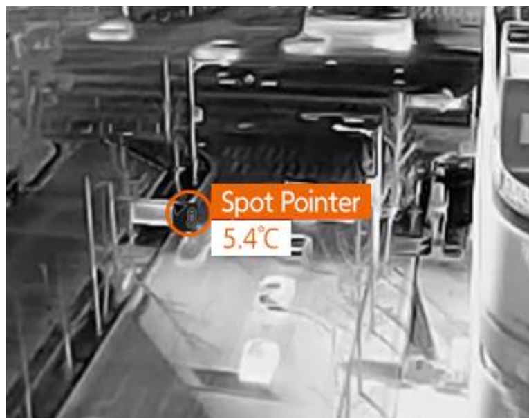
[그림 13. 스팟 포인터(Spot Pointer)를 이용한 온도 모니터링]
