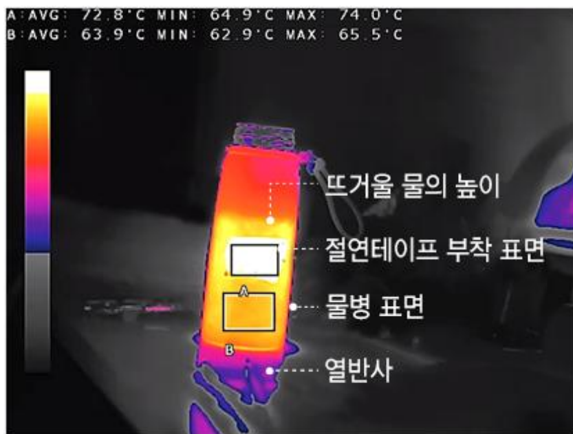
【图 21. 水筒に熱い水を入れたときの、放射率による熱画像の違い】
