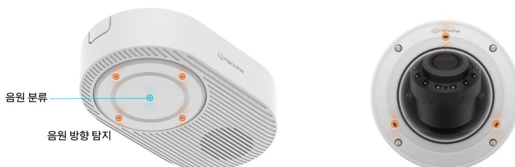
그림 3: 오디오 비콘 SPS-A100M(왼쪽)과 Wisenet 9 탑재 카메라의 마이크 위치
