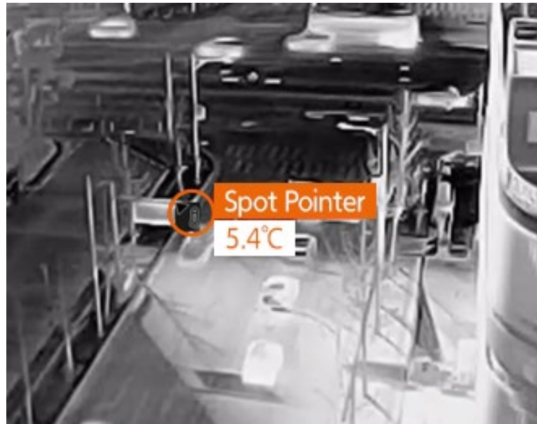
[그림 17. 스팟 포인터(Spot Pointer)를 이용한 온도 모니터링]
