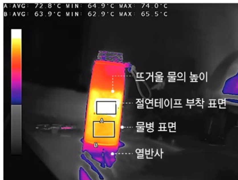
[그림 21. 물병에 뜨거운 물을 채웠을 때 방사율에 따른 열 영상 차이]
