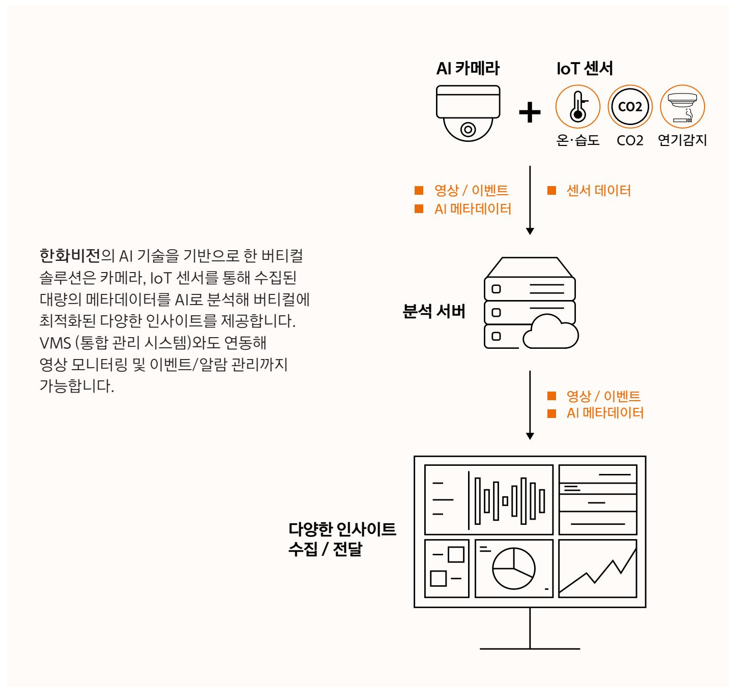
한화비전의 AI 기술을 기반으로 한 버티컬 솔루션은 카메라, IoT 센서를 통해 수집된 대량의 메타데이터를 AI로 분석해 버티컬에 최적화된 다양한 인사이트를 제공합니다. VMS (통합 관리 시스템)와도 연동해 영상 모니터링 및 이벤트/알람 관리까지 가능합니다.
