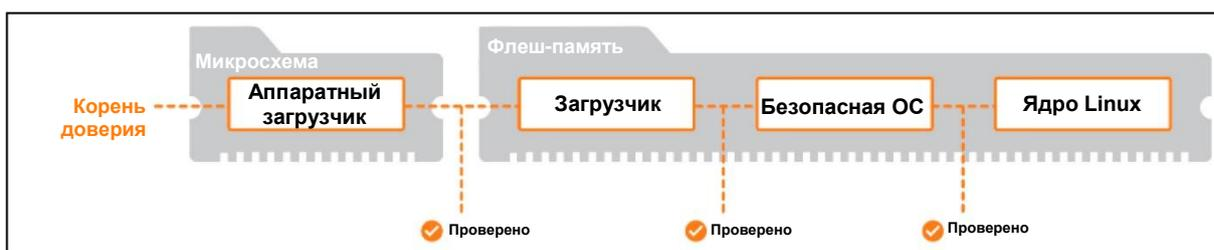
Рисунок 1. Безопасная загрузка в изделиях с Wisenet7
