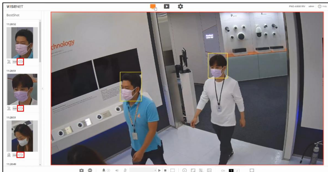
그림 4. Face mask detection 마스크 착용 감지 라이브뷰(Face Mask 속성 확인)
