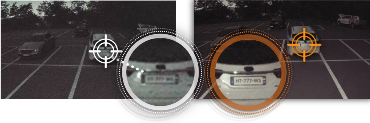
그림 3. 기존 자사 모델(좌)과 Wisenet7(우)의 노이즈 감소 기술 비교
