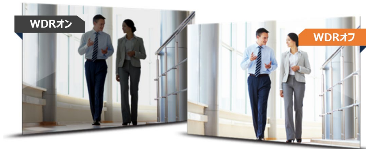
図 1. 周辺の背景が明るく対象物が暗く写る状況で WDR を適用
