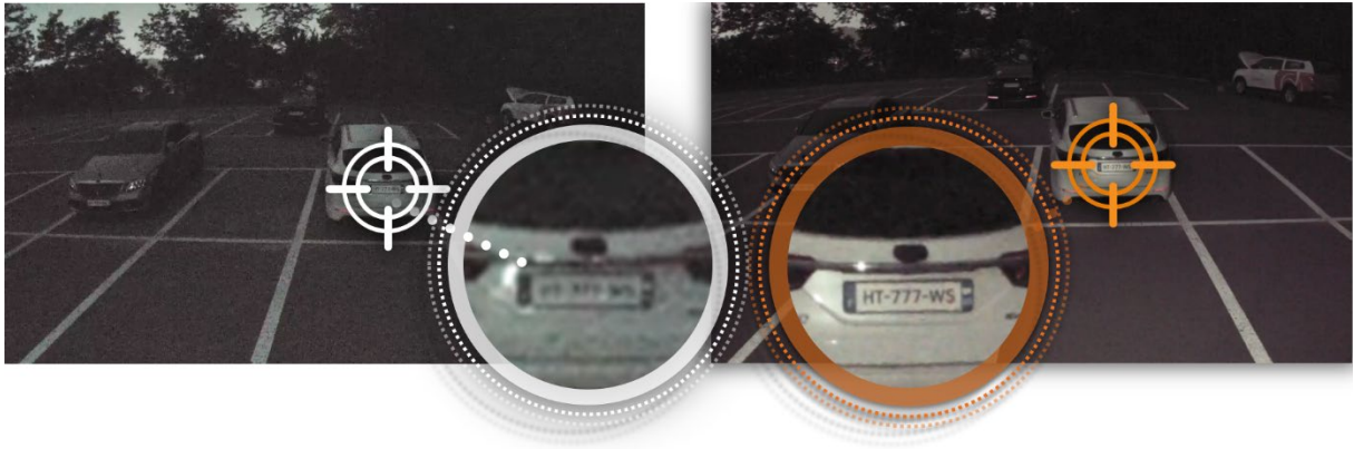
図 3. 既存自社モデル(左)と Wisenet7(右)のノイズ削減技術の比較
