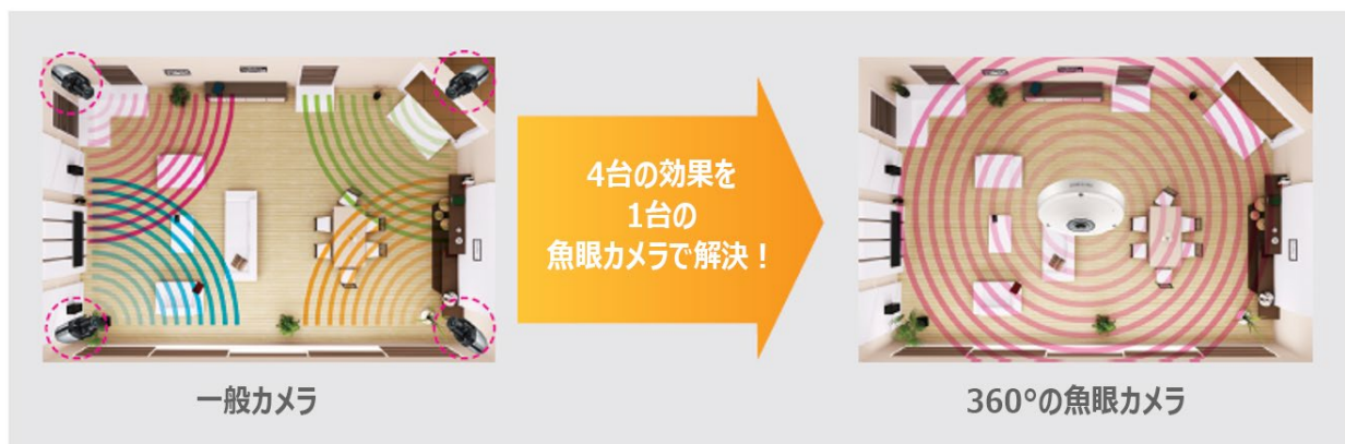
図 1. Fisheye と一般カメラの監視エリアの比較
